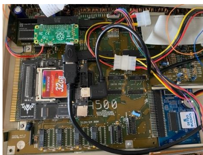
Eine Vampire V2+ Turbokarte auf einem Rev. 6a Board
